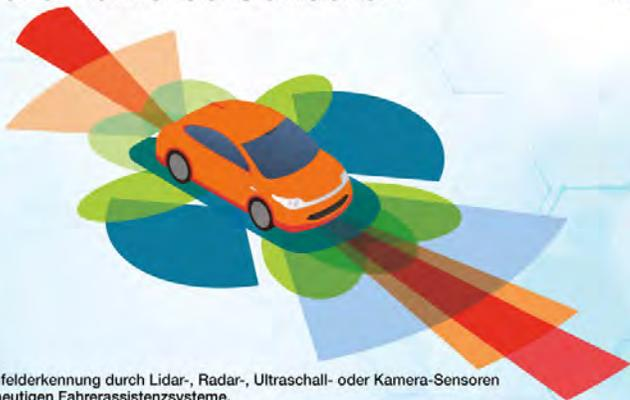
Umfeldererkennung durch Lidar-, Radar-, Ultraschall- oder Kamera-Sensoren in heutigen Fahrerassistenzsysteme.
