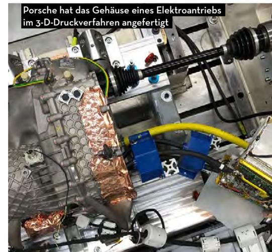
Porsche hat das Gehäuse eines Elektroantriebs im 3-D-Druckverfahren angefertigt
