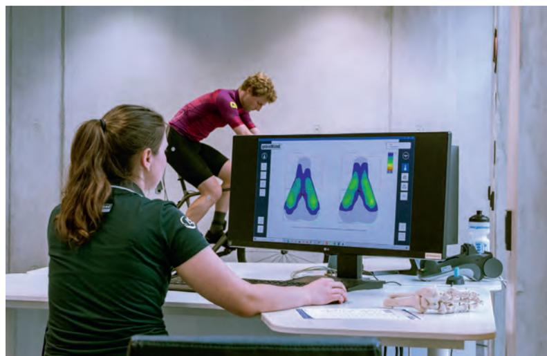
schwerden führt. Mit Kameratechnik und Satteldrucksensoren wird die optimale Sitzposition auf dem Rad gefunden. Sattel, Lenker und Vorbau werden so positioniert, dass die Sitzposition ergonomischen und biomechanischen Standards entspricht. Dadurch verbessert sich die Effizienz, der Sitz auf dem Rad wird spürbar komfortabler, Schmerzen oder Taubheitsgefühle werden reduziert oder verschwinden gänzlich. **COMFYTTTERS** bietet das Bikefitting für fast alle Fahrrad-Arten, auch E-Bikes an.
